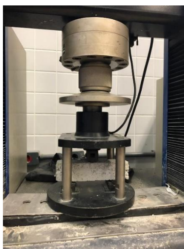
Figura 2- Prensa realizando ensaio de tração à flexão Fonte: Os Autores (2018)
