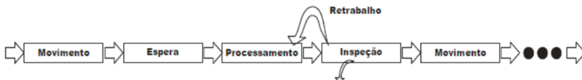
Figura 2 - Modelo do processo de conversão Lean Construction Fonte: ISATTO et. al. (2000)
