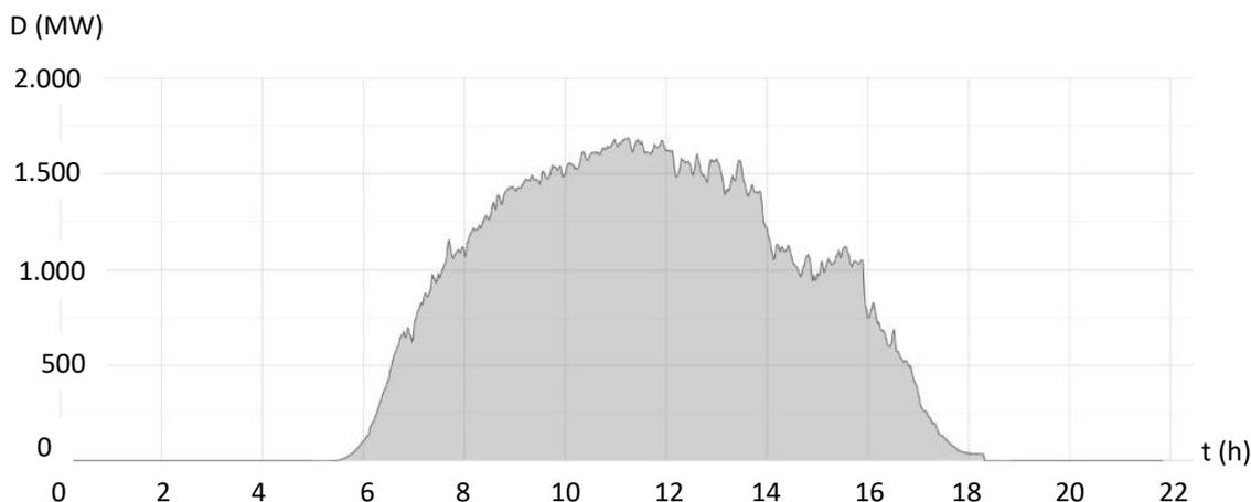
Figura 2 – Curva de geração de energia fotovoltaica do dia 07/10/2019. Nota: Leitura de sitio do ONS tempo real, realizada às 22h.
