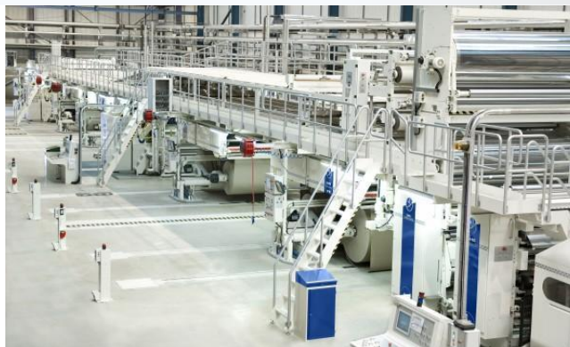
Figura 1 – Visão panorâmica - exemplo de uma máquina ondulateira (BHS, 2019)
