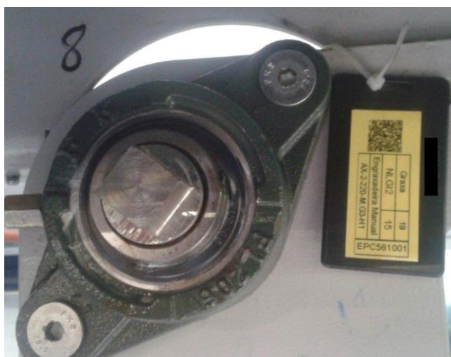
Figura 2: Mancal com placa de identificação
