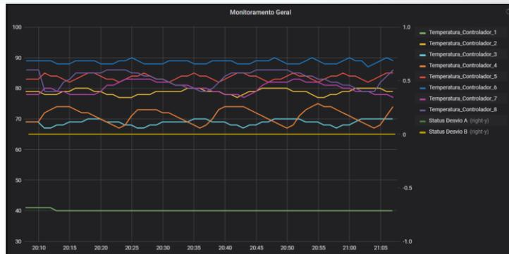
Figura 3 – Monitoramento de temperaturas no processo de produção. Fonte: Elaborado pelos autores (2019)
