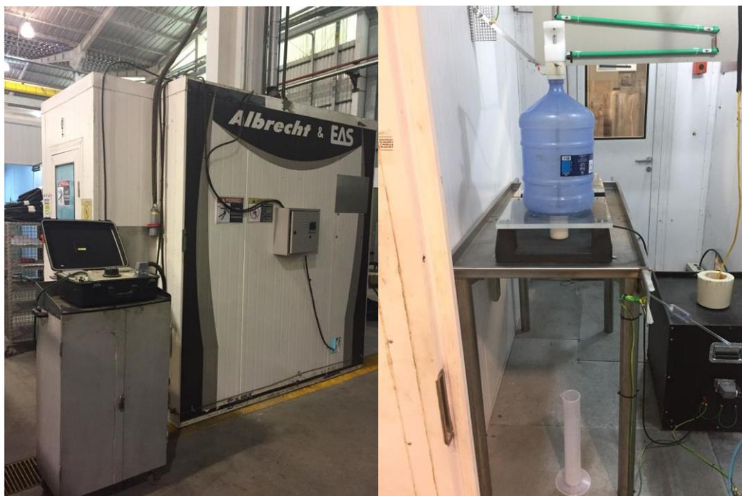
Figura 1. Aparato constuído em escala industrial para eletroneutralização de agrotóxicos e outros agentes tóxicos contidos em amostras de água
