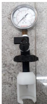
Figura 5 - Equipamento para determinação da pressão no interior de embalagem pet adaptado do modelo de Zahm - Nagel
