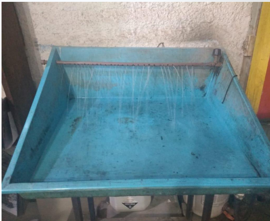
Figura 1- Tanque de lavagem
