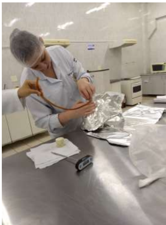
Figura 9 – Kitassato sendo fechado com rolha e recebendo papel alumínio como cobertura
