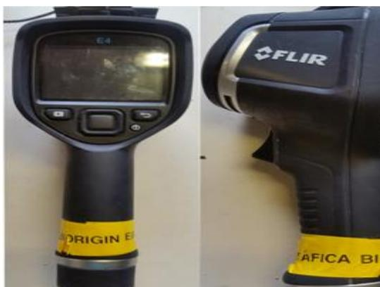
Figura 06 – Aparelho de análise termográfica
