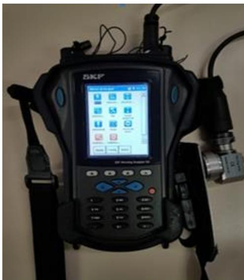
Figura 02 – Aparelho analisador de vibração; SKF Microlog Analyzer GX
