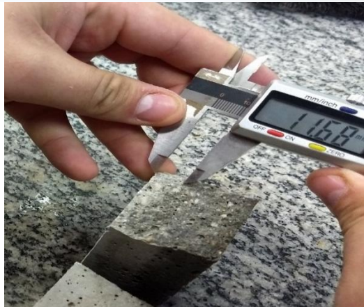
Figura 3 – Mensuração, em milímetros, da faixa seca no corpo de prova de cimento e areia
