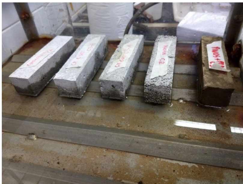
Figura 2 – Corpos de prova posicionados em recipiente com 5 mm de água em contato com a superfície lateral do corpo de prova
