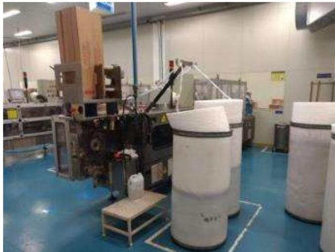
Figura 6 – Latas alimentando a máquina de hastes flexíveis
