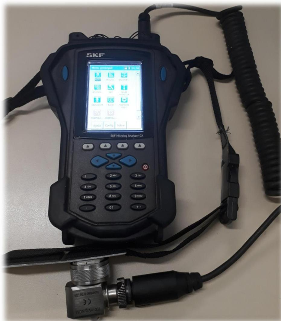
Figura 3 – Aparelho SKF Micrologo Analyzer GX CMVA75
