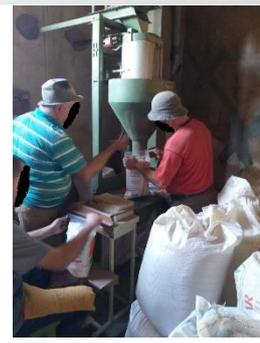
Figura 22. Processo de empacotamento e selagem.
