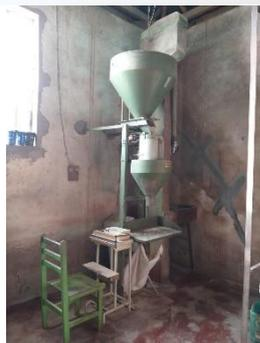
Figura 21. Equipamento de empacotamento/selagem.
