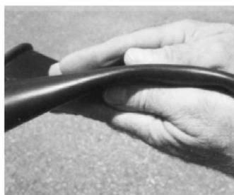
Figura 1. Técnica de rolagem: identifica defeitos nas luvas isolantes ASTM F1236
