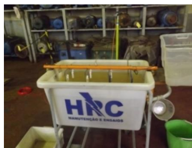
Figura 4. Tanque de testes de isolação de luvas
