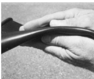
Figura 1. Técnica de rolagem: identifica defeitos nas luvas isolantes ASTM F1236
