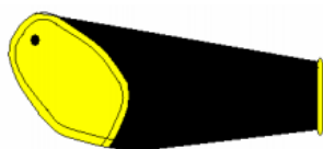
Figura 3. Manga isolante do estilo A que é apresentada em forma reta.
