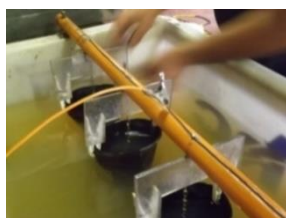
Figura 5. Tensão aplicada no interior da luva
