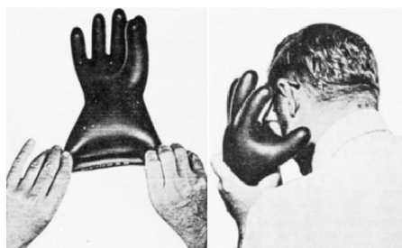
Figura 2. Testes em campo para detectar furos na luva nas luvas isolantes ASTM F1236
