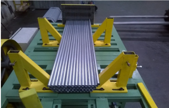
Figura 4 – Início das montagens dos fardos Fonte: Os autores, (2019)
