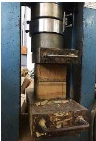
Figura 6 - Ensaio de Resistência à Compressão
