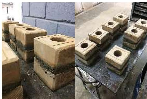
Figura 5 - Preparação dos corpos de prova
